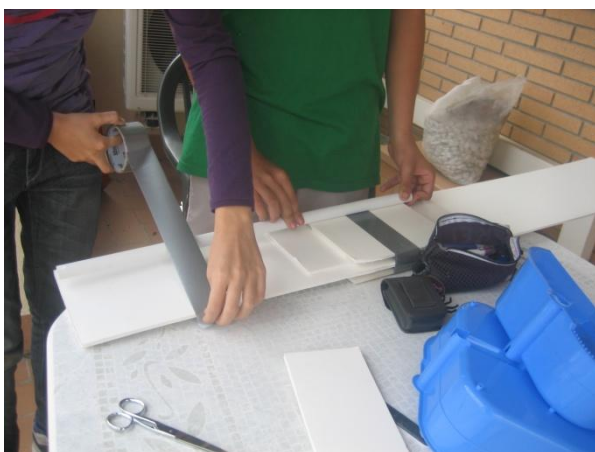
Figura 2: Fixant els pals de recollidor i els reforços.
