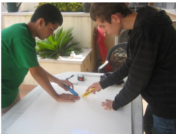
Figura 1: Tallant el cartró ploma amb el cúter.
